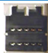
Рис.9. Разъем 5+5pin (Chrysler-2)
