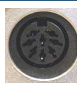
Рис.8. Разъем 8pin (Volvo, Honda, Chrysler-1)
