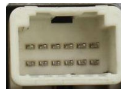
Рис.4. Разъем на штатном усилителе «Toyota 6+6»
